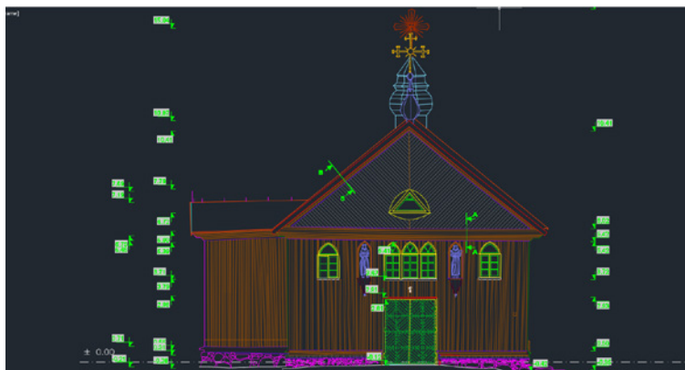
11 pav. CAD brėžiniai, parengti pagal taškų masyvą. Paimta iš VŠĮ „Paveldo komunikacija“ projekto sukurtos medžiagos.
