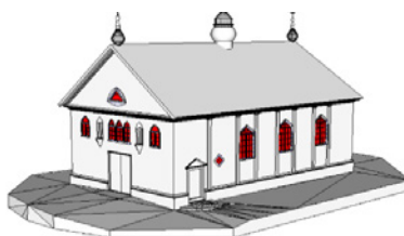
12 pav. Parengto supaprastinto 3D bažnyčios modelio panaudojimas plotų skaičiavimams. Paimta iš VŠĮ „Paveldo komunikacija“ projekto sukurtos medžiagos.
